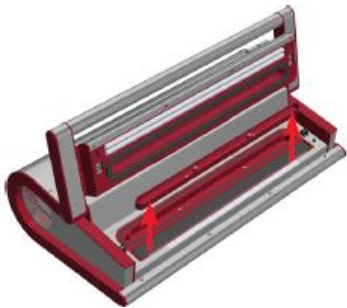
Abbildung 7: Wenn Flüssigkeit in den Behälter eingelangt, ziehen Sie den Behälter einfach hoch, gießen Sie die Flüssigkeit aus und trocknen Sie den Behälter gründlich.
